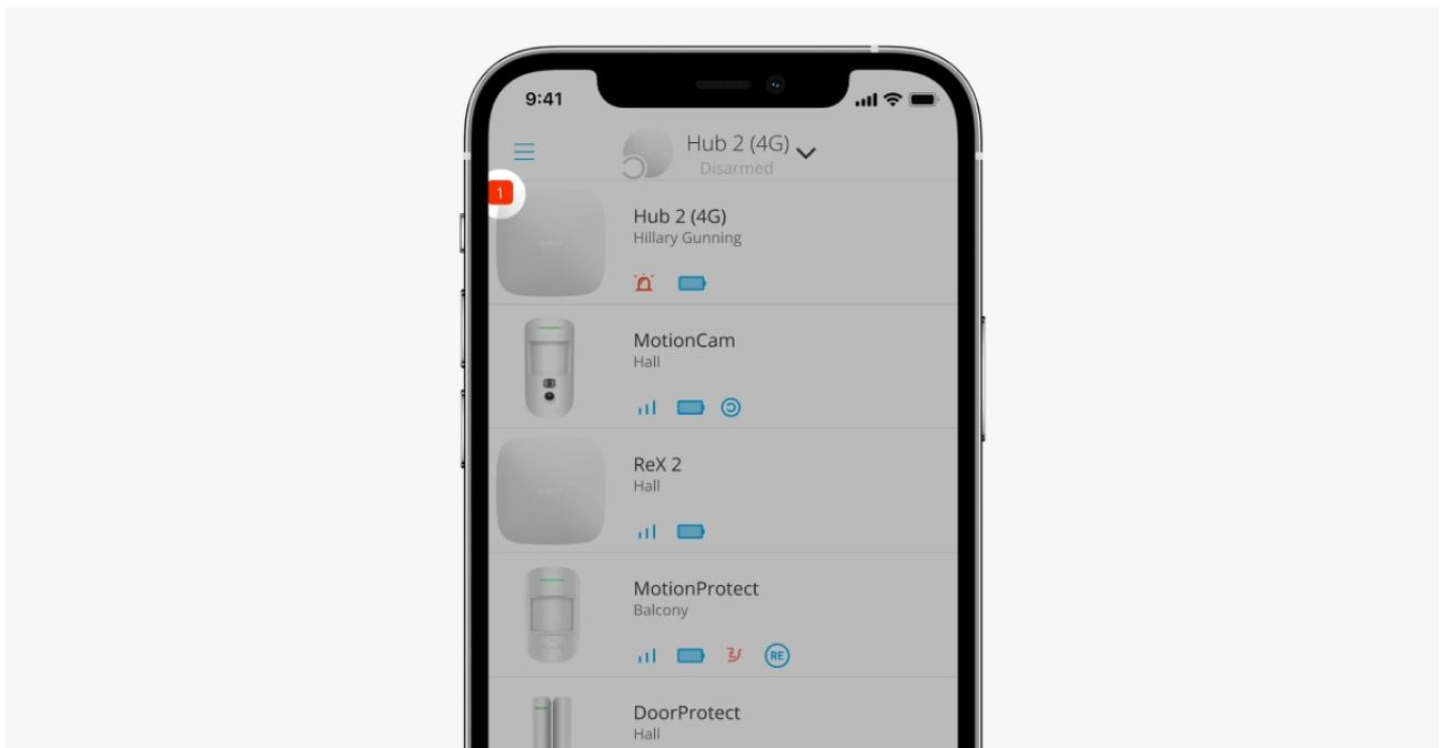
Si se detecta un error del hub (por ejemplo, no hay alimentación externa disponible), se muestra un contador de errores en el icono del dispositivo, en la app Ajax.
