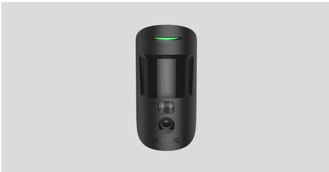
**El MotionCam (PhOD) Jeweller** es un detector inalámbrico de movimiento compatible con la verificación fotográfica de alarmas, **Foto bajo demanda** y **Foto por escenario** detalles. Destinado para uso en interiores. Puede detectar movimiento a una distancia de hasta 12 metros. Ignora mascotas cuando se instala y configura correctamente.
