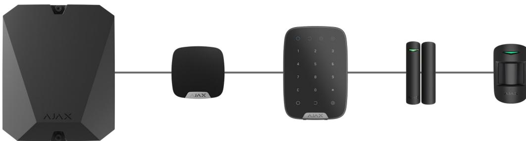
Al utilizar la topología **en serie**, asegúrese de instalar una resistencia de terminación de 120 Ohm al final de la línea (está incluida en el kit del hub). Esta se conecta a los terminales de señal del último detector de la línea.
