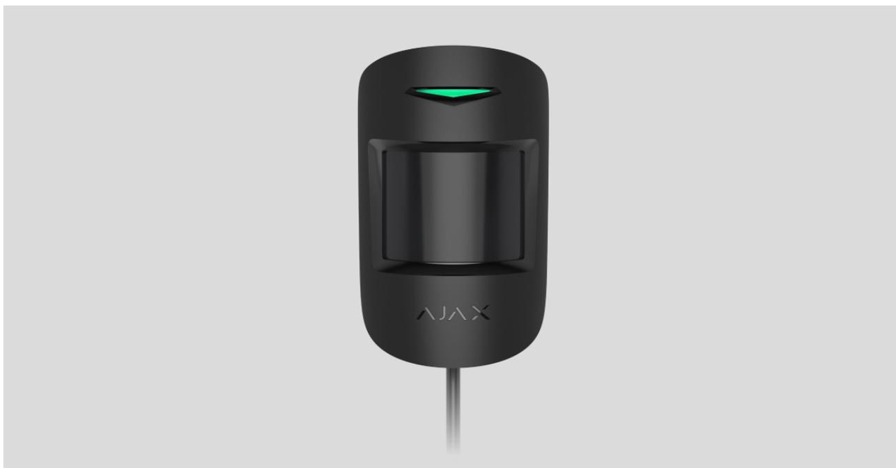
El **MotionProtect Fibra** es un detector cableado de movimiento equipado con un sensor infrarrojo. Puede detectar movimiento a una distancia de hasta 12 metros. No responde a la presencia de mascotas de hasta 50 centímetros de altura y con un peso de hasta 20 kilogramos. Está diseñado para su instalación en interiores.
