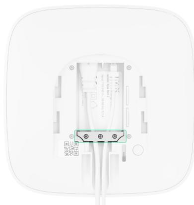
4. Deslice el ReX 2 en el panel de montaje. Tras la instalación, compruebe primero el modo tamper en la app Ajax y luego la calidad de la fijación del panel. Recibirá una notificación si se realiza un intento de arrancar el repetidor de la superficie o de quitarlo del panel de fijación.
