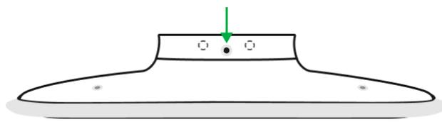
14. Conecte la fuente de alimentación externa y la batería de reserva del hub. Encienda el hub.
