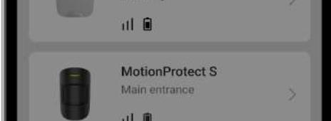
**Cuando se detecta un fallo de funcionamiento, la app Ajax muestra un contador de fallos de funcionamiento en el icono del dispositivo. Todos los fallos de funcionamiento se muestran en los estados del detector. Los campos con fallos de funcionamiento se resaltarán en rojo.**
