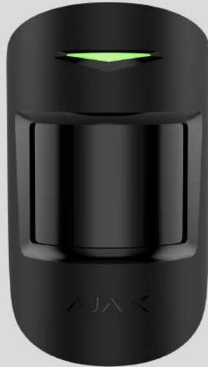
**El Superior MotionProtect Plus Jeweller es un detector inalámbrico de movimiento. Detecta el movimiento a una distancia de hasta 12 metros. Ignora las mascotas cuando está instalado y configurado correctamente. El detector utiliza el sensor IR y un escaneo de radiofrecuencia con un sensor de microondas de banda K que filtra las interferencias térmicas. El dispositivo está diseñado para su instalación solo en interiores.**
