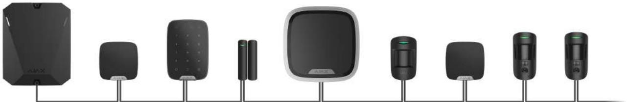
La topología en anillo ocupa dos salidas de línea del hub. En el caso de que se rompa el anillo en un punto, no se desactivará ni un solo dispositivo. Se formarán dos líneas que seguirán funcionando como siempre. Los usuarios y la compañía de seguridad recibirán una notificación en caso de rotura.
