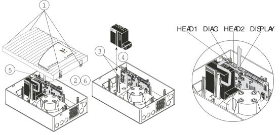
Replacing a detector module
