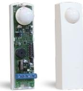
Detector a rayos infrarrojos pasivos, capaces de crear una barrera de protección del tipo "cortina" útil para puertas y ventanas. Tiene un alcance regulable de 2 a 3,5 mts y está dotado de algunas funciones especiales: led de alta potencia luminosa para luz de cortesía y/o alarma; sistema de reconocimiento de la dirección de la alarma; buzzer con sonoridades diferentes en función de la dirección de la violación; sistema de retraso de activación.
