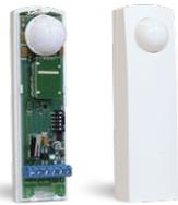
Detector DT, rayos infrarrojos y microonda a 10 Ghz adecuado para crear una protección de tipo "cortina" para puertas y ventanas. Tiene la protección anti-sabotaje, el dispositivo tamper anti-apertura, un led de señalización con relativo jumper de des-habilitación. Dispone de sistema de reconocimiento de la dirección de la alarma.
