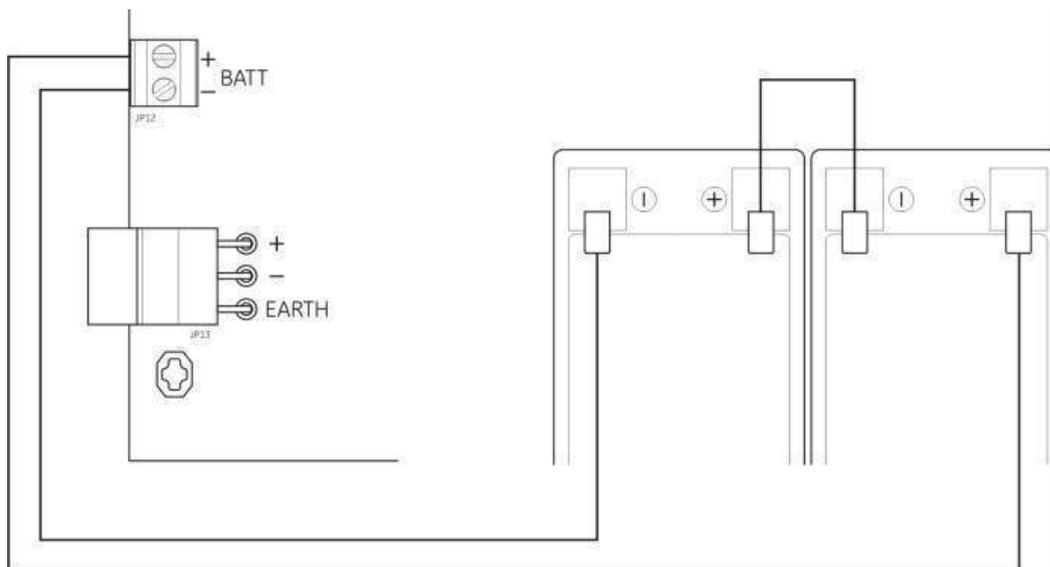
**Precaución:** Peligro de daños al equipo. No se debe conectar ningún otro equipo al conector BATT.
