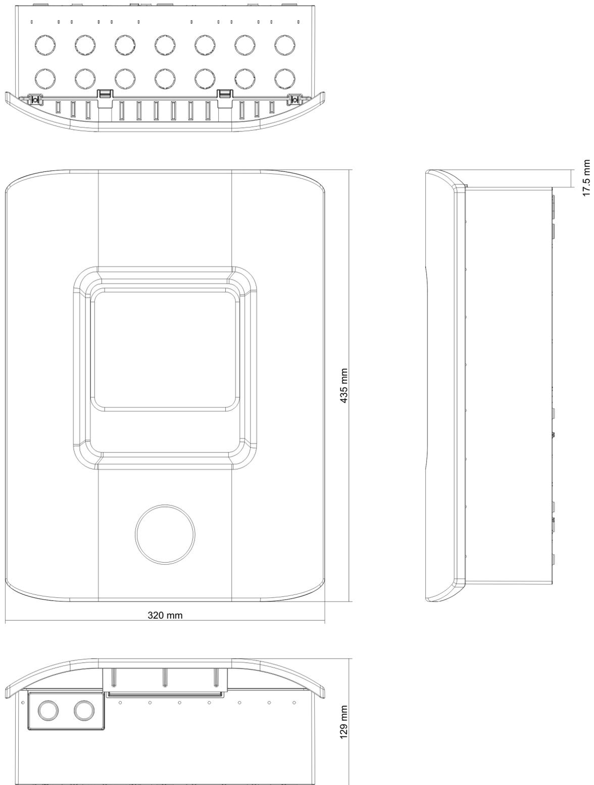
Figura 22: Módulo de dos y cuatro zonas sin cubierta
