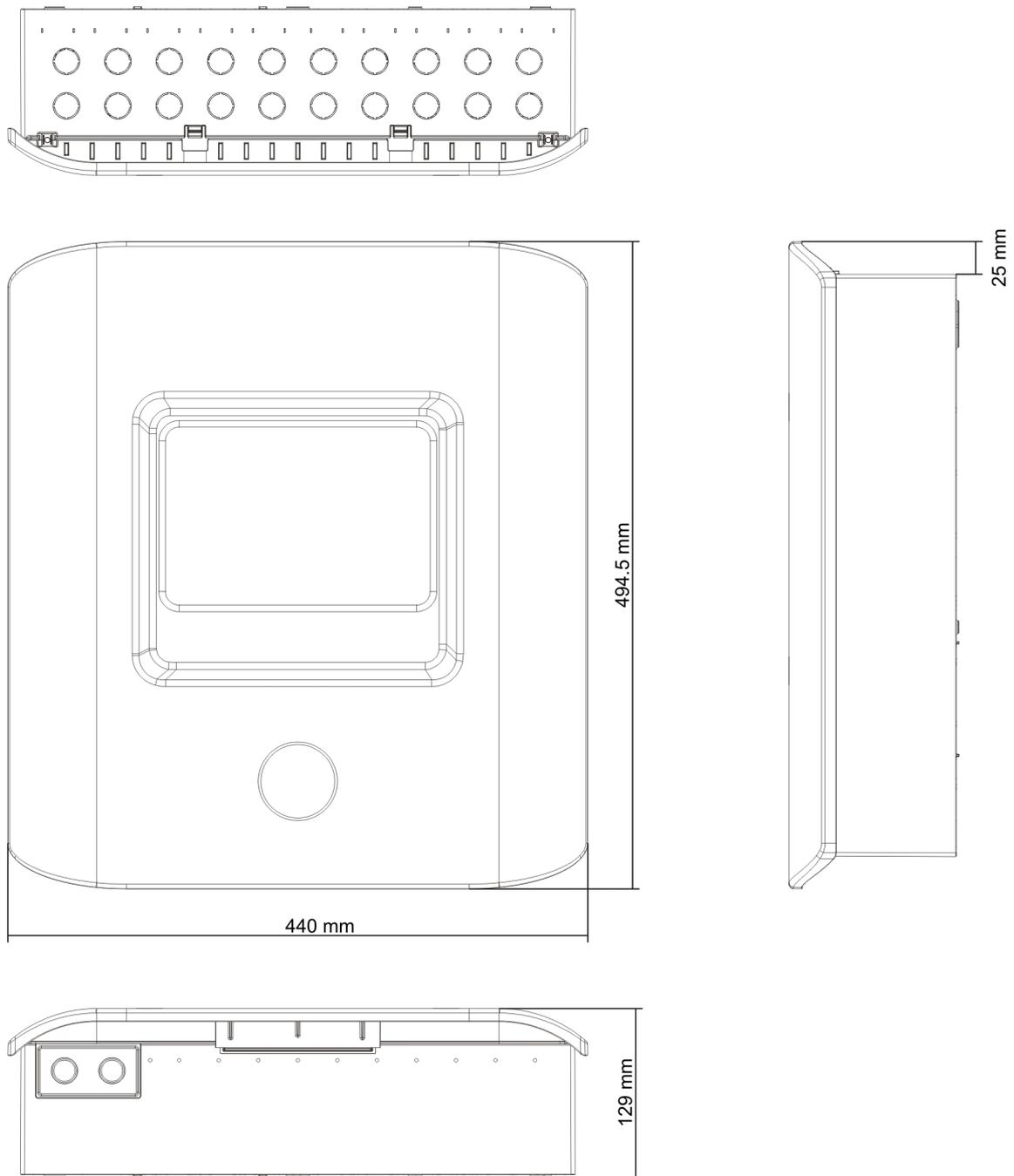
Figura 24: Módulo de ocho zonas sin cubierta
