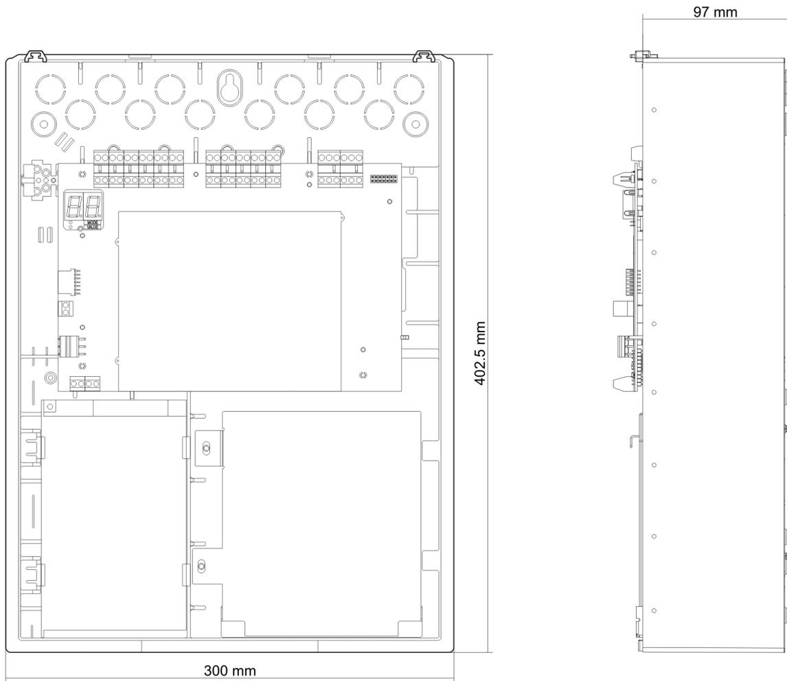
Figura 23: Módulo de ocho zonas con cubierta
