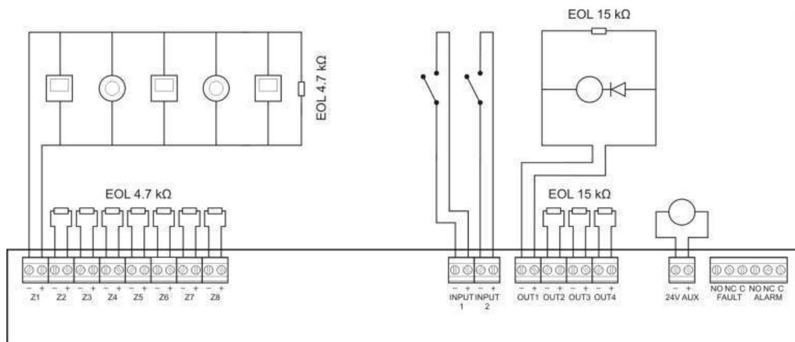
Figura 5: Conexiones del sistema de detección EN 54-13
