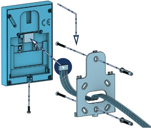
1. Conectar los cables en la instalación.
