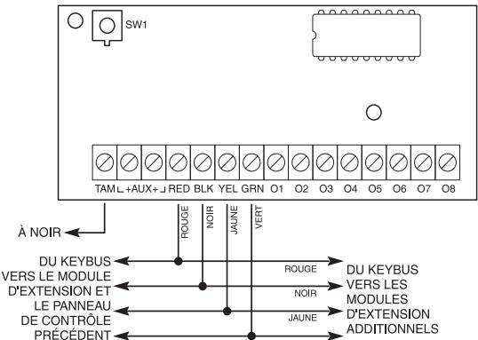
**TAM** - Elle peut être utilisée pour protéger le coffret dans lequel le PC5208 est monté. Connectez un interrupteur normalement fermé (NF) entre TAM et BLK (noir). Si l'anti-sabotage n'est pas utilisé, connectez un fil entre TAM et BLK (noir).
