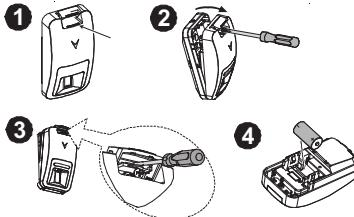
1. Na localização indicada, levante a tampa do parafuso para cima usando seu polegar.
