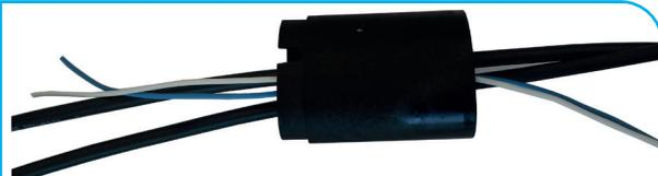
Insertar los cables que se deberán soldar al circuito impreso a través de los orificios de la tapa.
