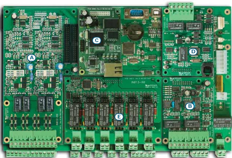
Figura 7 - Módulo base equipado con los módulos opcionales
