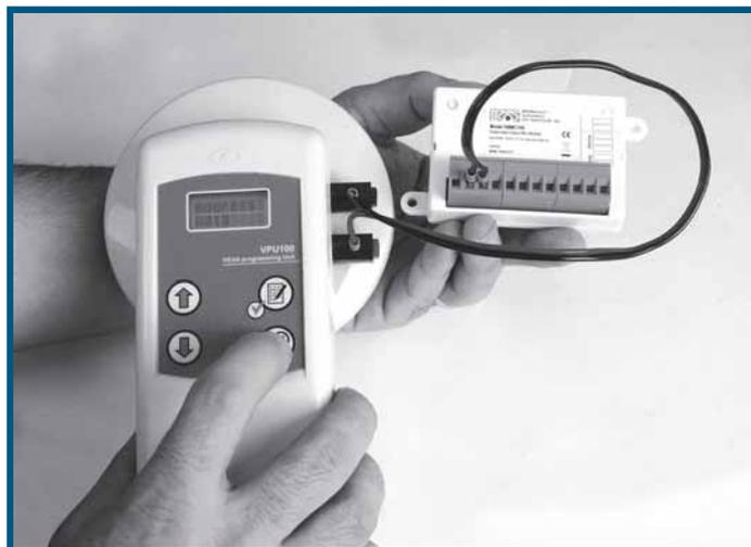
Figura 34 - Programación de los módulos con VPU100
