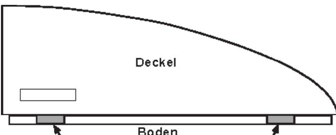
Führen sie einen Schraubenzieher zuerst in Schlitz 1 und danach in Schlitz 2 ein um den Deckel zu öffnen
