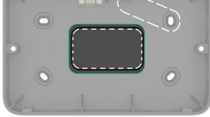
**Para pasar el cable por el lateral, la parte superior o la parte inferior, puede taladrar orificios siguiendo los huecos de la carcasa del módulo, teniendo en cuenta el tamaño de los prensacables. Hay dos huecos a cada lado del módulo. Recomendamos utilizar una sierra de perforación para plástico de hasta Ø20 mm.**
