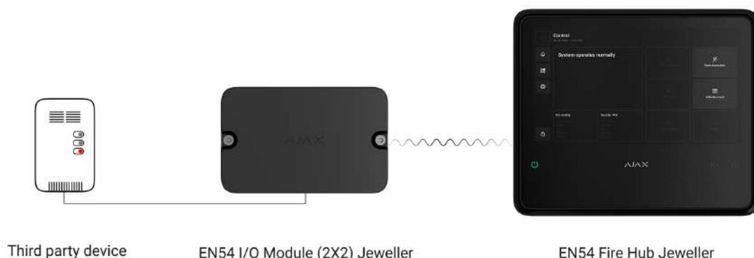
El módulo se alimenta mediante baterías preinstaladas y no necesita una alimentación externa. El EN54 I/O Module (2X2) Jeweller monitoriza su estado operativo e informa al sistema de los fallos que se produzcan.
