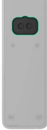
4. Introduzca el cable en la carcasa del teclado a través del orificio hecho.
