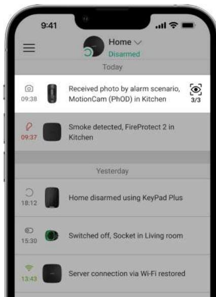
La función **Foto por escenario** permite crear un escenario para detectores de movimiento con verificación fotográfica. Estos detectores tomarán fotos en caso de alarmas de dispositivos Ajax especificados.
