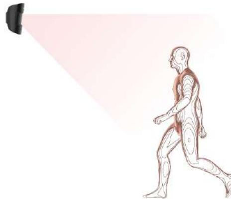
El detector debe instalarse **a una altura de 2,4 metros** sin ninguna obstrucción en su área de detección, por ejemplo, en la esquina de la habitación, donde no se bloqueará su visión con armarios, muebles u otros obstáculos.
