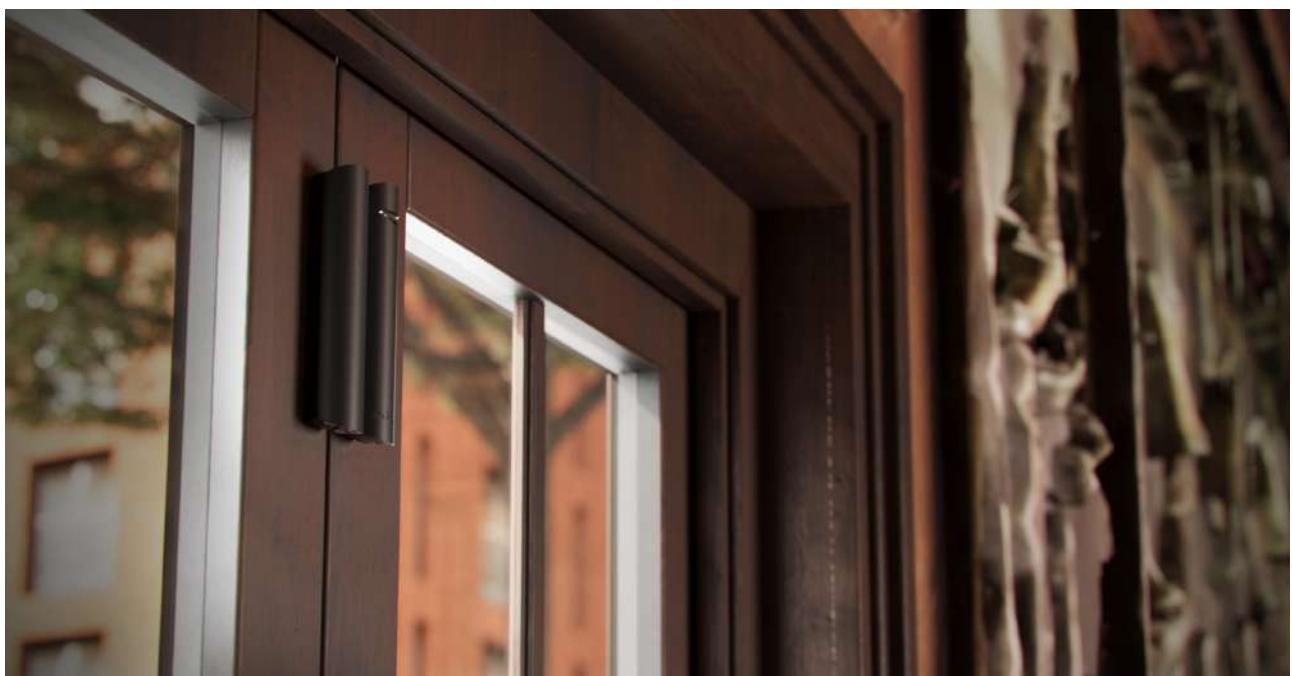
**Si solo desea utilizar el sensor de impacto y/o inclinación, no necesita instalar el imán cerca del detector. Puede desactivar los sensores de apertura y de enmascaramiento magnético en los ajustes del Superior DoorProtect G3 Jeweller.**
