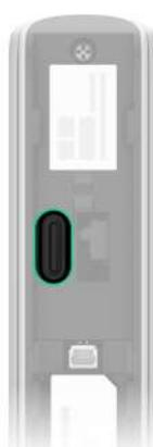
**Si la conexión falla, inténtelo de nuevo en 5 segundos. Si ya se ha añadido el dispositivo, pulse el botón de encendido durante 3 segundos.**
