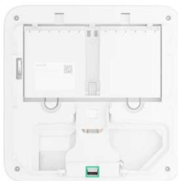
**3. Conecte los cables Ethernet y de alimentación a los conectores correspondientes.**
