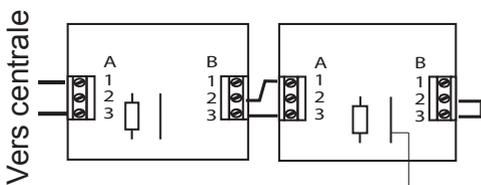
Couper le strap sur le dernier BBG en cas de surveillance de ligne ou remplacer le shunt en B2-B3 du dernier BBG par la résistance désirée.
