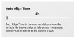
Este valor viene ajustado de fábrica a 4 horas, pero puede ajustarlo a entre 0 y 12 horas en función de su entorno.
