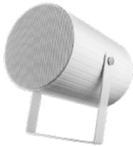
Difusor acústico tipo proyector. Montaje mediante soporte metálico de sujeción incluido, basculante, carcasa de aluminio, rejilla metálica para proteger la parte vista. Admite líneas de 70 V o 100 V, mediante interruptor selector puede ajustarse para suministrar 5 / 10 / 20 W de potencia.
