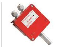
Detector de temperatura de absorción (para centrales convencionales) de la serie TMP2-D, caja en aluminio con grado de protección IP66. 2 entradas para cables desde arriba, 2 prensacables M20 incluidos. Restablecimiento automático.
