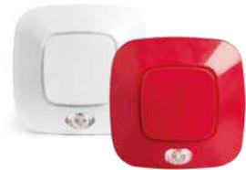
Indicador óptico/acústico que funciona de 20 a 30 V DC, grado de protección IP65. Mediante DIP SWITCH, se puede seleccionar el tono de alarma eligiendo entre los 14 disponibles y regular el volumen y la potencia del indicador intermitente.
