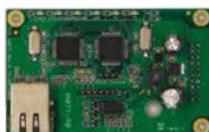
SmartLAN/SF permite conectar a una red de Ethernet y permite los accesos remotos vía Internet a la central y a todas las que están conectadas con esta en la red HorNet. La tarjeta ofrece la posibilidad de realizar la programación (up-downloading) de los datos en remoto, y de controlar el sistema mediante el software de control SmartLook. Implementa el protocolo Modbus en TCP-IP.
