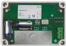
El módulo de entrada WM110 está equipado con una entrada supervisada y es compatible con trasladadores direccionables EWT100 o expansiones XWT100.
