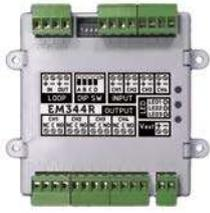
El módulo se conecta al bucle y pone a disposición diversas entradas y salidas según el modelo (vea la tabla). En las versiones equipadas con 4 entradas, 2 de estas pueden configurarse como zonas convencionales o entradas de 4-20 mA, alimentadas por el bucle o de una fuente de alimentación local. Las 4 salidas están, en función del modelo, supervisadas para la gestión de señales ópticas/acústicas o de los contactos limpios.
