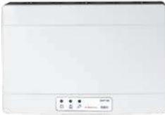
Se reconoce en el bucle como un dispositivo con dirección Inim y ocupa, además de la suya, una dirección para cada dispositivo de radio asociado a él. El trasladador puede gestionar directamente hasta un máximo de 32 dispositivos vía radio o, añadiendo módulos de expansión XWT100, hasta un máximo de 128 dispositivos. Se alimenta desde el bucle o desde una fuente de alimentación local conectando un alimentador de 24 V.
