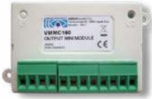
Los módulos de la serie Argus permiten supervisar el estado de dispositivos externos (módulos de entrada) o de controlar dispositivos o actuadores externos (módulos de salida). Los módulos incluyen un aislador de corto circuito y están disponibles en la versión Mini (96 x 52 mm) o de pared (86 x 86 mm)
