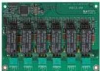
Introduciendo dicha tarjeta en la central, se tendrán a disposición 6 terminales adicionales. Cada terminal se puede configurar como salida supervisada (NAC - 1 A máx.), entrada supervisada o línea de entrada para sensores convencionales. En la fase de programación es posible establecer las causas de activación de estas salidas o las acciones que se producen cuando se activan las entradas.
