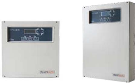
SPS24060G y SPS24160G, estaciones de alimentación (respectivamente de 1,5 A y de 4 A) con pantalla LCD de control, donde se puede consultar el registro de los eventos, visualizar los detalles de posibles averías (baterías descargadas, falta de red, dispersiones hacia la tierra, etc.) y de la absorción de corriente de cada salida; 3 salidas protegidas de forma independiente con una limitación de corriente de 4 A.
