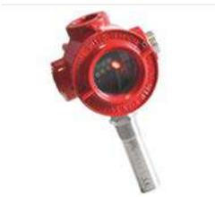
Detector de temperatura de absorción (para centrales convencionales) de la serie TMP2-JO y TMP2-TO, caja antideflagrante certificada ATEX. Restablecimiento automático. Certificación ATEX II 2G Ex d IIC T6
