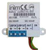
Gracias a su pequeño tamaño, puede instalarse directamente dentro del dispositivo que se debe controlar (pulsador de alarma, sirena, detector lineal, etc.), se conecta al bucle y se equipa con una entrada supervisada (para controlar el estado de un dispositivo), una salida alimentada directamente por el bucle (para controlar una dispositivo de señalización acústico o óptico/acústico).
