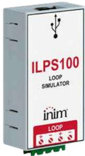
Se conecta a los terminales de bucle de los paneles de control Inim y simula hasta 240 dispositivos, lo que permite probar el funcionamiento de un bucle y verificar fácilmente la configuración y la lógica de activación causa/efecto sin tener que conectar físicamente los dispositivos. Se conecta a un PC a través del puerto USB (desacoplado eléctricamente para no interferir con la central y generar fallos a tierra) y gracias al software «ILP Simulator» es posible:
