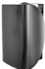
Altavoz acústico de pared de dos vías (altavoz de 6,5", tweeter de 1,5"). Montaje superficial mediante soporte metálico de sujeción incluido, basculante, carcasa de plástico ABS ignífugo, rejilla metálica para proteger la parte vista. Admite líneas de 70 V o 100 V, mediante interruptor selector puede ajustarse para suministrar 5 / 10 / 20 / 40 W de potencia.
