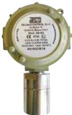
Están equipados con una interfaz de 4-20 mA con una escala completa del 20% L.I.E. (versión K) o una escala completa del 100% L.I.E. (versión P) para los detectores de gases explosivos y de 300 ppm para el detector de CO. El detector proporciona una operación práctica de verificación, calibración y prueba eléctrica usando las dos llaves en el circuito, el gas titulado de los cilindros de prueba se puede aplicar al elemento sensible usando los adaptadores TC011 o TC014.
