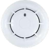
Basado en la tecnología Tyndall de difusión de la luz, el detector ID100 es capaz de dar una respuesta rápida y eficaz apenas se produce el conato de incendio, siendo capaz de detectar una amplia gama de partículas que se producen debidas a la combustión. El diseño de la cámara, con la parte superior del detector sellada, la red con malla de 500 micrones para prevenir la entrada de insectos, aseguran una alta inmunidad a falsas alarmas.
