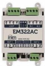
Se conecta al bucle y dispone de dos entradas supervisadas (capaces de controlar el estado de un dispositivo externo) y de dos relés capaces de controlar cargas con tensión de red 230 V AC. Para cada uno de los dos relés de salida es posible activar la función de supervisión que permite comprobar si, en condiciones de relé en reposo, hay tensión en los extremos del contacto.
