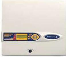
El sistema Stratos HSSD2 es capaz de gestionar hasta cuatro tubos de muestreo con una longitud máxima de 100 m cada uno (con una longitud máxima total de los 4 tubos de 200 m). Tiene un panel con teclado y pantalla LCD en la parte frontal, donde es posible controlar los estados de funcionamiento y las condiciones de alarma.
