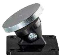
Las contraplacas de las series S01 utilizan un disco de acero montado sobre un amortiguador especial capaz de absorber parte del impacto provocado por la apertura de la puerta. La elasticidad del amortiguador también permite un perfecto acoplamiento del disco al imán.
