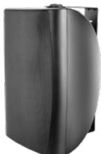
Altavoz acústico de pared de dos vías (altavoz de 5", tweeter de 1,5"). Montaje superficial mediante soporte metálico de sujeción incluido, basculante, carcasa de plástico ABS ignífugo, rejilla metálica para proteger la parte vista. Admite líneas de 70 V o 100 V, mediante interruptor selector puede ajustarse para suministrar 7,5 / 15 / 30 W de potencia.
