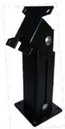
Extensión telescópica S03150 para topes electromagnéticos S2. Utilizado en los casos en que el electroimán, instalado en la pared, esté demasiado alejado de la puerta para poder sujetarlo. La extensión permite separar el electroimán de la pared de 150 a 220 mm.
