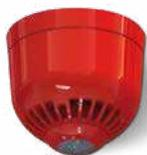
Parte óptica certificada según la nueva norma EN54-23 con base de montaje. Tono seleccionable entre los 32 disponibles mediante interruptores DIP switch interno, la frecuencia de parpadeo 0,5Hz/1 Hz (seleccionable con DIP SWITCH), volumen que se puede seleccionar entre 2 niveles.
