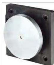
Las contraplacas de las series S02, SH2, S00 utilizan un disco de acero montado sobre un amortiguador especial capaz de absorber parte del impacto provocado por la apertura de la puerta. La elasticidad del amortiguador también permite un perfecto acoplamiento del disco al imán.
