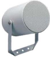
Difusor acústico tipo proyector. Montaje mediante soporte metálico de sujeción incluido, basculante, carcasa de plástico ABS ignífugo, rejilla metálica para proteger la parte vista. Admite líneas de 70 V o 100 V, mediante interruptor selector puede ajustarse para suministrar 5 / 10 / 20 W de potencia.
