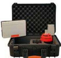
El estuche se compone de: un transmisor de prueba, un detector de prueba, un adaptador Bluetooth y un transmisor de radio para la comunicación con la aplicación Android. El kit le permite realizar pruebas de posicionamiento y evaluar la señal de radio antes de instalar el sistema. El valor de la señal de radio transmitida por el detector de prueba y el transmisor de prueba se puede ver en la aplicación para sistemas Android (teléfono inteligente-tableta) que se puede descargar desde la tienda.
