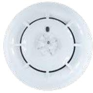
El detector puede configurarse en los siguientes modos: A1R (umbral fijo a 58 ° C y detección termovelocimétrica), B (Umbral fijo a 72 ° C), A2S (Umbral fijo a 58 ° C), BR (umbral fijo a 72 ° C con detección termovelocimétrica). Gracias a su alta versatilidad puede usarse en todas las condiciones donde sea difícil detectar el humo o se corra el riesgo de una falsa alarma.
