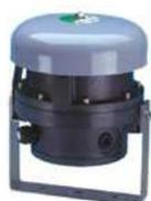
La campana Explosion Proof está diseñada para uso en áreas clasificadas como Zona 1 y 2. Grado de protección IP66, certificado ATEX II 2G Exd y IIC T6.
