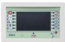
Unidad de control principal para las funciones voice EVAC. Si se coloca en la ranura superior, se instala en el panel frontal y se conecta a la barra CANDRIVE+, mientras que si se coloca en la ranura inferior se conecta al módulo FPM de la ranura superior. Presenta una pantalla gráfica de colores con sistema de mando táctil. Su función consiste en la gestión y la coordinación de los módulos funcionales. Una sola central Previdia UltraVox puede alojar una sola de estas unidades.
