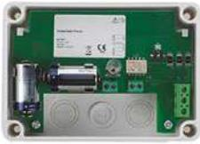
El módulo de salida WM202SR está equipado con una salida de relé (contacto limpio) y una salida supervisada capaz de suministrar una tensión de 12 o 24 V DC partiendo de la batería interna. El módulo es gestionado completamente por la central (si combinado con las centrales con direccionamiento).
