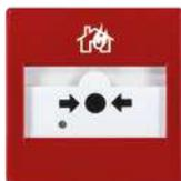
Pulsador de alarma reiniciable, se puede conectar al bucle y gestionar mediante paneles de control de incendios direccionables analógicamente. En la parte frontal del pulsador se encuentran presentes la parte activa para realizar la activación y un LED que indica el estado del dispositivo. Una vez activado, el pulsador puede restablecerse mediante la llave de restablecimiento suministrada en el embalaje.
