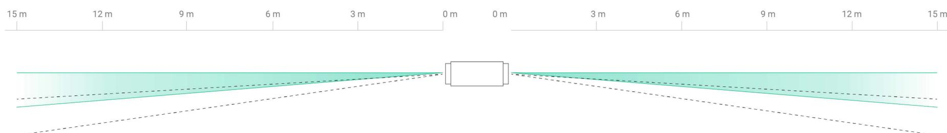
El ángulo de dirección del haz se puede inclinar a 3° para evitar las partes sobresalientes de un edificio
