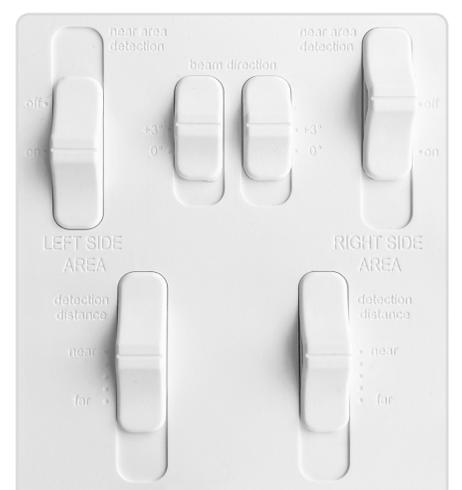
**Cada lado** del DualCurtain Outdoor permite que la distancia y la dirección de la zona de detección sean ajustables. Ayudan a ajustar el detector según la arquitectura y garantizan una detección precisa de las amenazas.
