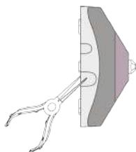
2. Para el cableado empotrado, pase el cable por la apertura bajo la placa de conexión.
