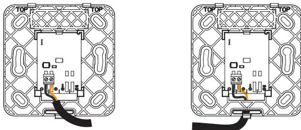
3. Sujete el cable con una abrazadera en la placa base.
