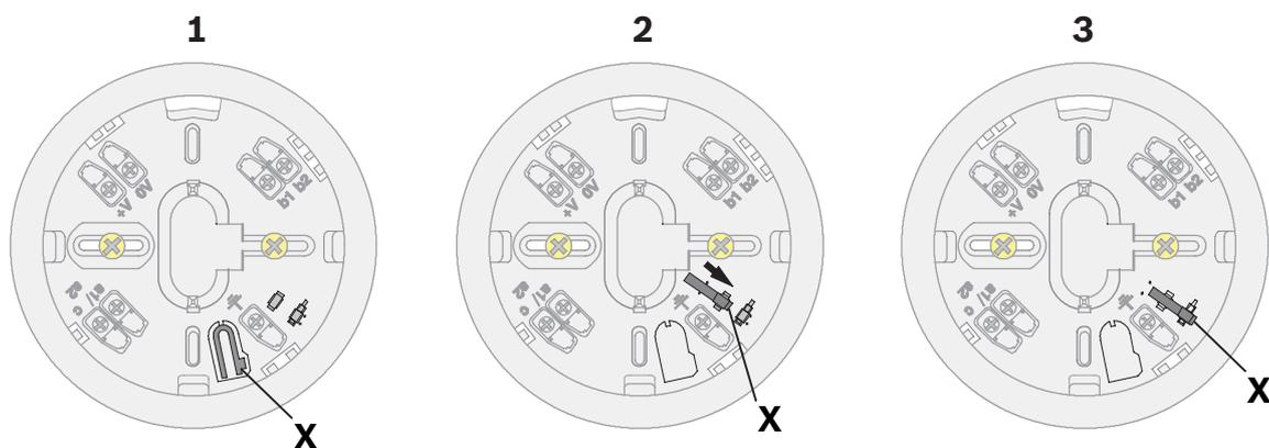
**Figura 4.1:** Activación de la protección contra extracción
