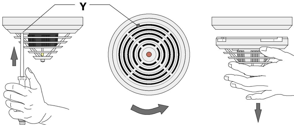
**Figura 4.2:** Extracción del detector (detector bloqueado)
