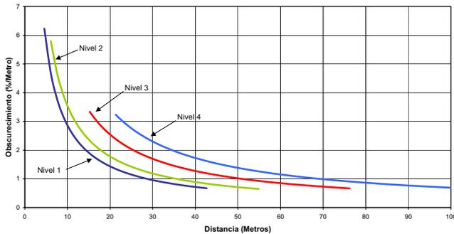
Aparte de las cuatro opciones de sensibilidad estándar, el detector dispone de dos niveles autoajustables (A1 y A2). Cuando se selecciona uno de estos valores, el detector ajusta automáticamente su sensibilidad mediante el uso de algoritmos avanzados para establecer la sensibilidad óptima para el ambiente. La sensibilidad se ajustará continuamente dentro de los rangos especificados en la Gráfica 1.
