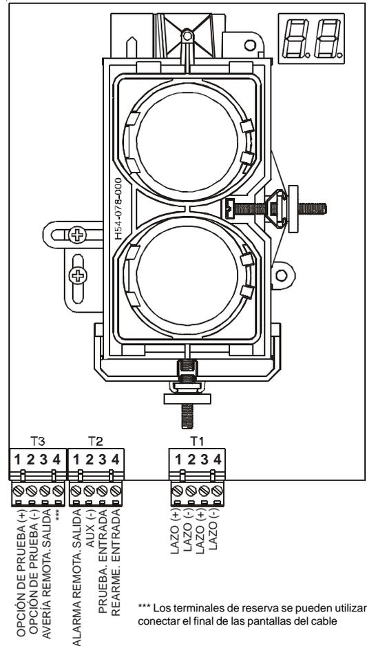
Figura 3: Conexiones de los terminales del detector
