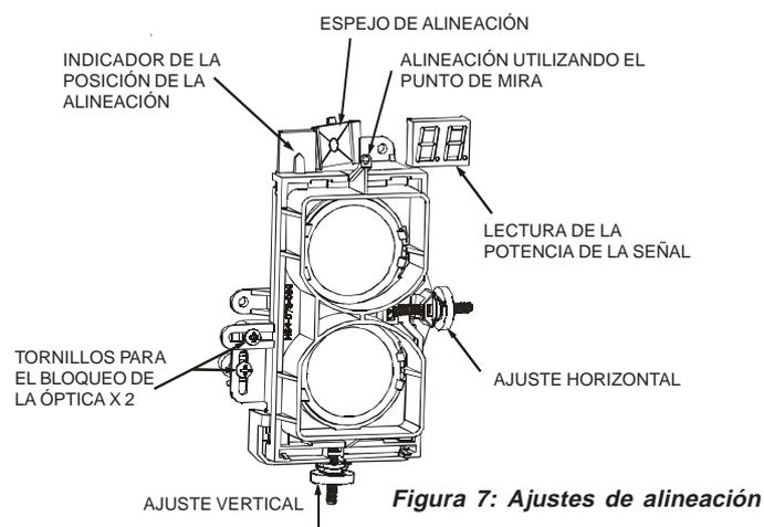
Figura 7: Ajustes de alineación
