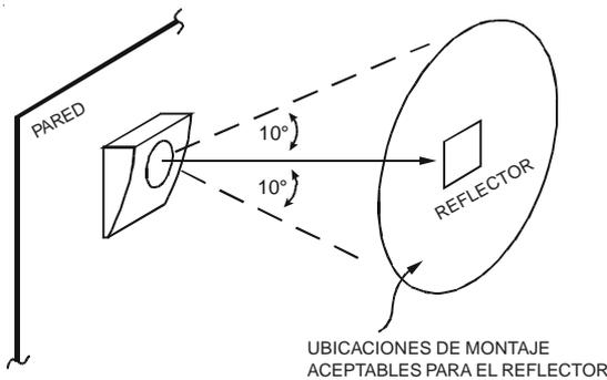
Figura 2a: Instrucciones para el montaje del reflector
