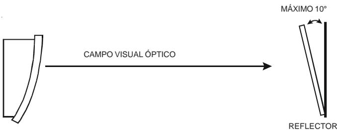
Figura 2b: Instrucciones para el montaje del reflector
