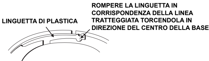
Figura 3b: Rimozione del gateway dalla base con funzione antimanomissione attivata
