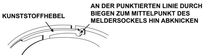
Abbildung 3a: Aktivierung der Entnahmesicherung
