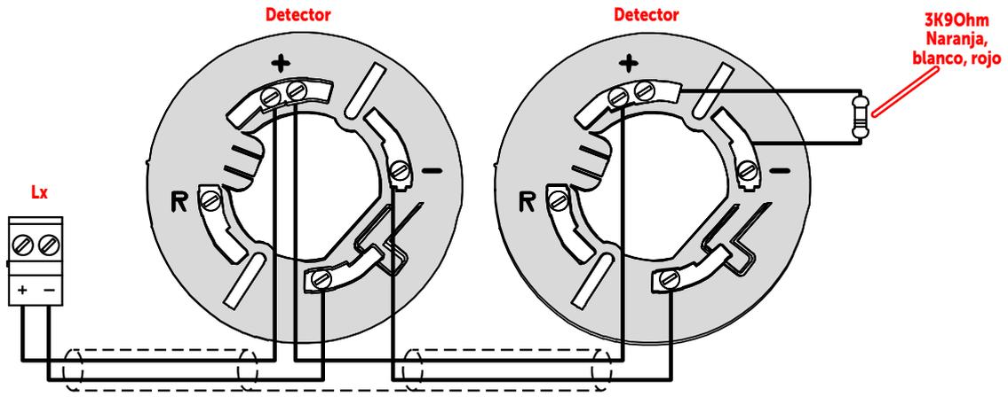
**Conexión de detectores de gas con relé**
