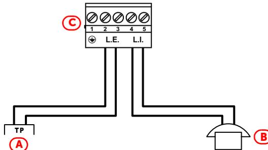
Conectar la línea telefónica [A] a los bornes "L.E." y el aparato telefónico o la línea interna [B] a los bornes "L.I." de la placa ([C], apartado 2.4 - [B]).
