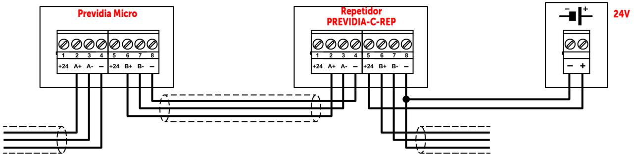
El dispositivo alimentador utilizado, en tal caso, debe ser conforme con las normas EN54-4.
