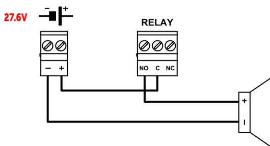
Todos los contactos libres de potencial de relé tienen que conectarse solo a circuitos que operen con tensión SELV.
