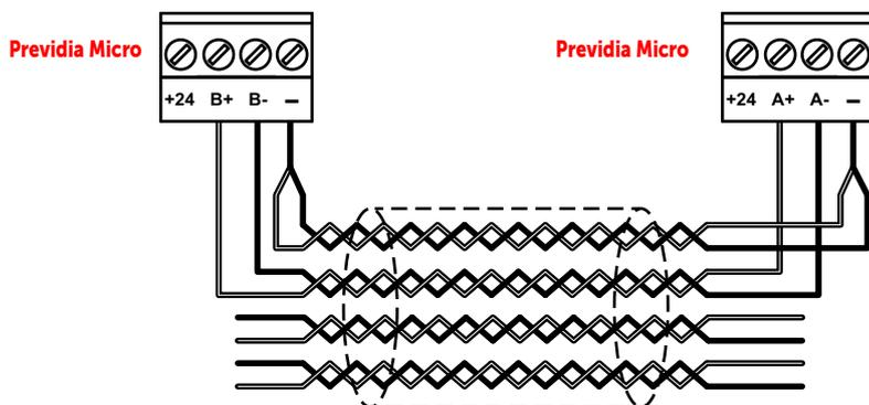
**Cables:** Si el cable se utiliza para alimentar repetidores, utilice los terminales "+24".
