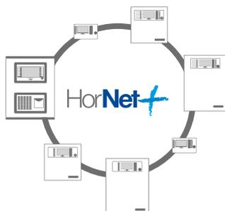
Para aumentar la extensión de la instalación pueden conectarse en red varias centrales Previdia (hasta un máximo de 48 puntos entre las centrales y el repetidor), de manera que se construya un sistema de mayor capacidad (red Hornet+).
