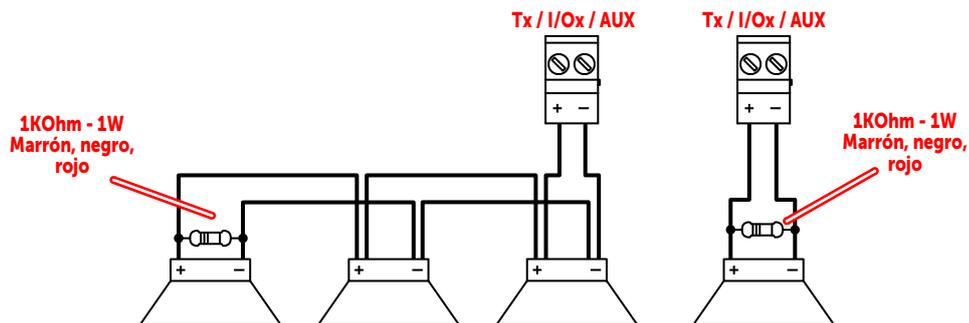
Las polaridades se refieren a la condición de salida activa, en condiciones de reposo las polaridades resultan invertidas.
