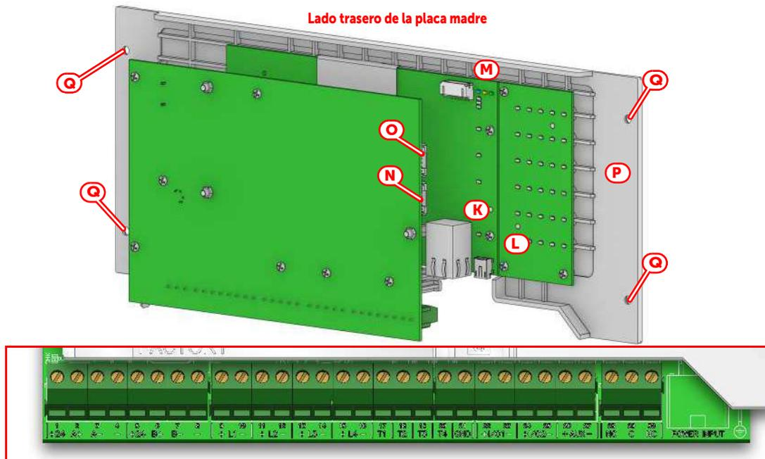
**Bornes de los terminales de conexión**
