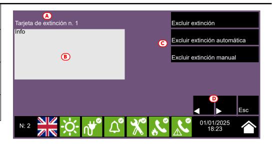
A continuación, las teclas función del módulo IFMEXT, la activación o el acceso a éstas, dependen del nivel de acceso del usuario.
