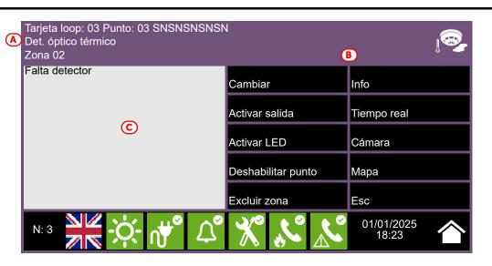
A continuación, las teclas función del dispositivo, la activación o el acceso a éstas, dependen del nivel de acceso del usuario.
