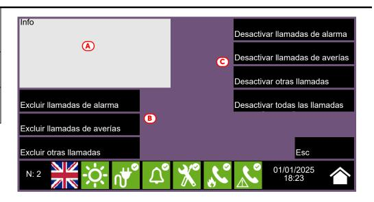
A continuación, las teclas función del módulo IFMDIAL, la activación o el acceso a éstas, dependen del nivel de acceso del usuario.
