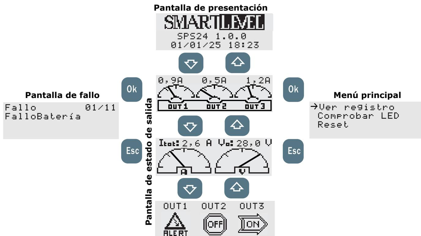
Figura 17 - Navegación en las pantallas del display
