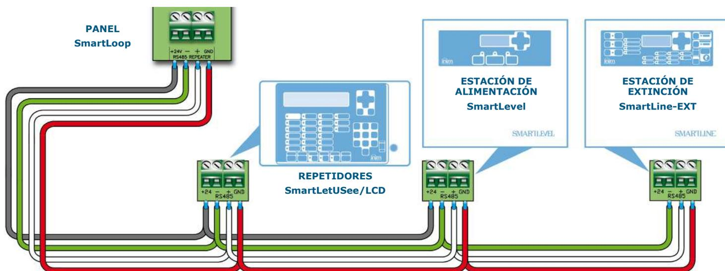
**Figura 11 - Conexión BUS RS485**
