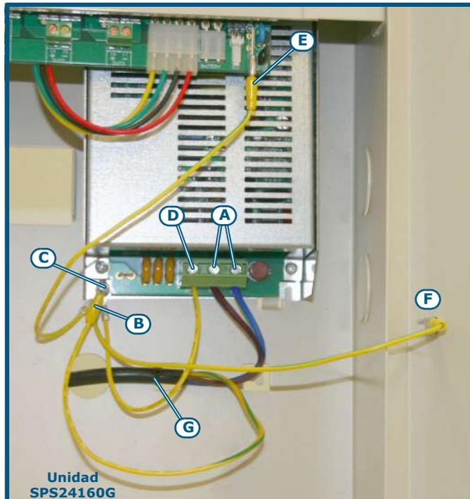
**Figura 13 - Conexión de tierra**
