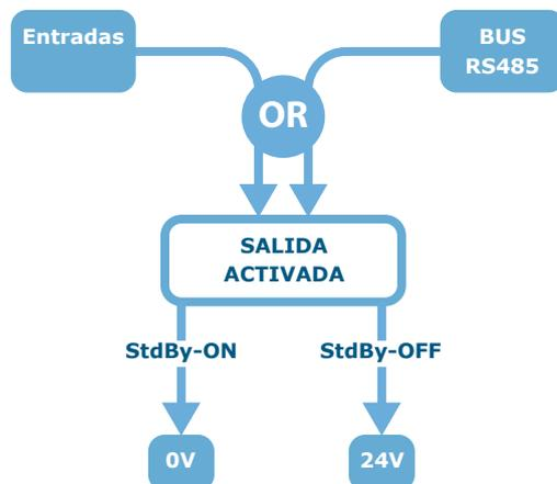
**Figura 3 - Activación de la salida**
