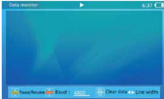
Funcionamiento: Pulse **+** para configurar la velocidad en baudios para que sea consistente con el cable RS485 probado. Los datos aparecerán en la pantalla cuando el comprobador los reciba.
