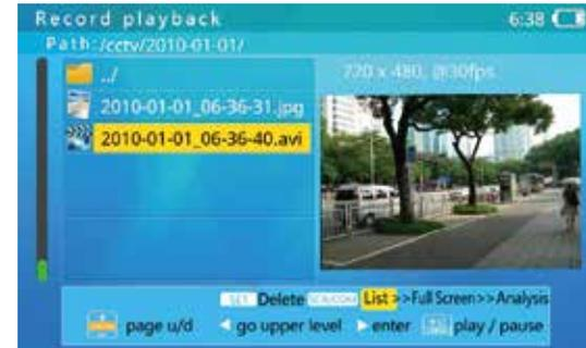
En modo de análisis de imagen, pulse **[SCR]** para ver el vídeo a pantalla completa. Pulse **[+]** y **[+]** para reproducir un fotograma. Pulse **[+]** para pausar o reproducir y **[▶]** para avanzar rápido/retroceder.
