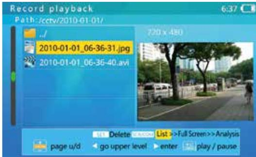
Pulse el botón **[SCR]** para mostrar la fotografía a pantalla completa en el modo de selección de fotografías. Pulse de nuevo **[SCR]** para acceder al modo de Análisis de imagen (Image Analysis). Púlselo para eliminar los archivos en ambos modos.
