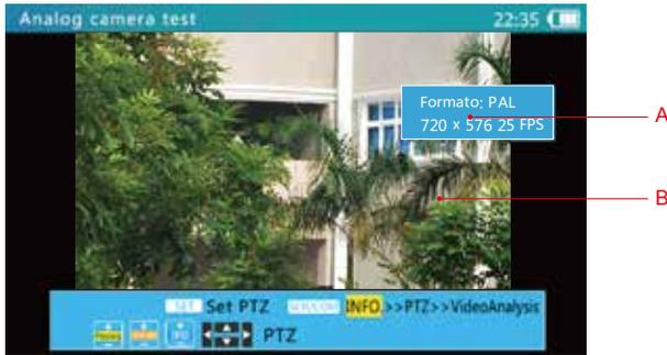
**!** El vídeo anterior es la señal de la cámara analógica. Si no hay entrada de señal o si no se puede comprobar la señal, en la interfaz aparecerá "No hay entrada de vídeo" (No video input).
