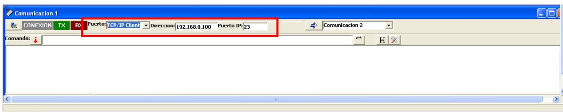
Para conectar y configurar el UCIP, seleccione la comunicación deseada (Arriba), y configúrela para conectar con el UCIP por la IP por defecto en modo Consola de comandos.
