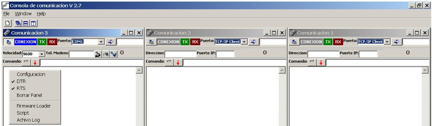
**Configuración:** Configuración del puerto serie de su PC para comunicar con el UCIP/UCIP-GPRS por puerto serie UART1. Depende de la velocidad configurada en UCIP; por defecto 9600 Bds, 8 bit datos, Sin paridad, 1 bit stop, sin control de flujo.
