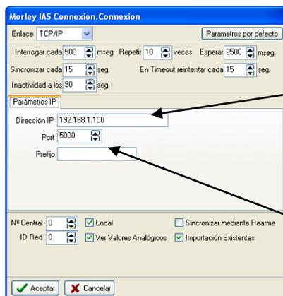
**IP del UCIP** (TG trabaja con IP fija y modo TCP/IP):
